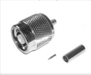
RTNC-Stecker (RTNC-m) für RG 316, crimp
